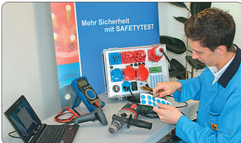
Bild 10: Prüfgerät für Netze 400V/3~ oder 230V/1~, Prüfung von Verlängerungen mit Gerätesteckern/Steckdosen möglich (optional: Prüfen nach DIN EN 60974-4, Prüfen von Schweißgeräten)
