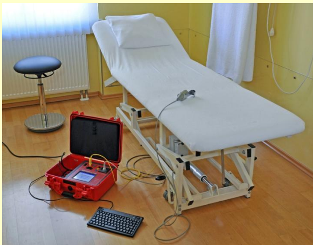
Prüfungen nach DIN VDE 0751-1 an einer elektromotorisch einstellbaren Behandlungsliege mit dem BENNING ST 750.
