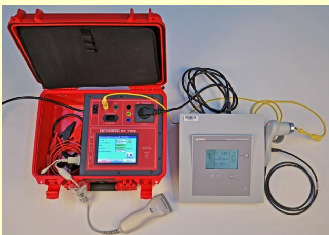
Prüfung nach DIN VDE 0751-1 am Anwendungsteil eines Ultraschall-Therapiegerätes. Prüflingsidentifikation mittels Barcodescanner und Barcodeaufkleber am Gerät.
