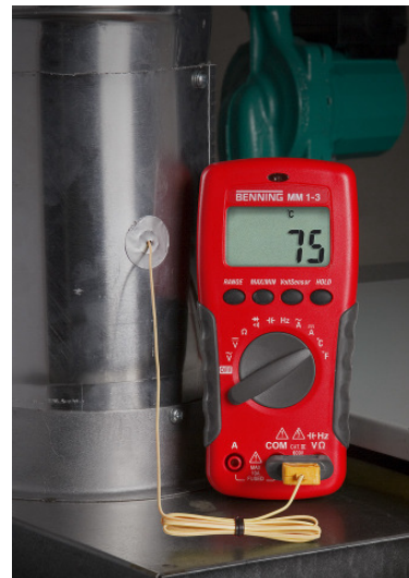
BENNING MM 1-3, Messung der Abgastemperatur einer Heizungsanlage
