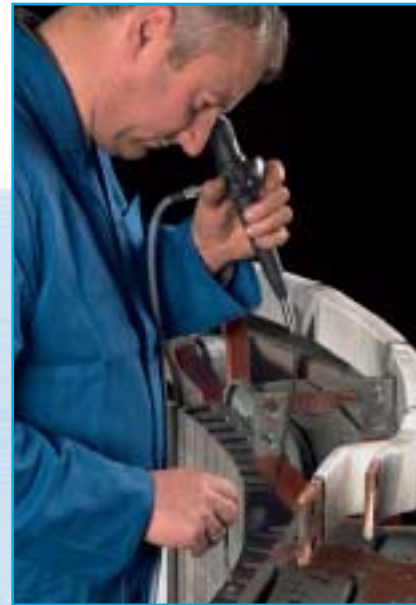
► Untersuchung eines Blechpaketes mit der flexiblen Endoskopieleitung.
