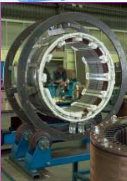
► Die Neufertigung eines Elektrostanderpaketes mit neuem Blechpaket sowie neuen Spulen und Schaltbrücken.
