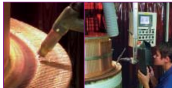
Die Kommutator Wig-Verschweißung wird auf einem CNS-Schweißautomaten im thermisch schonendem Verfahren einzelpunktverschweißt. (Abb. oben)
