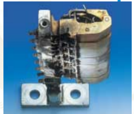
Schaden an einem 800 kW GS Motor durch abgelaufene Kohlebürsten. Damage on a 800 kW DC motor because of worn out carbon brushes.
