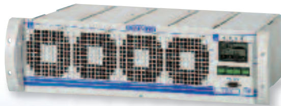
Abb. 2: 19" Gleichrichtereinschub modular mit 4 Modulen TEBECHOP 3000 I und Fernüberwachung MCU 2500, Ausgangsspannung 110 V, Ausgangsstrom 80 A
