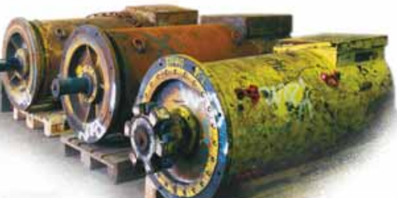
Bilder: (Sch) Motoren nach dem Eingang und nach der Fertigstellung
