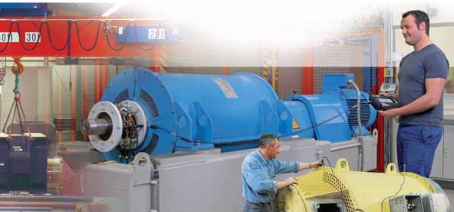
Endprüfung einer magnetischen Kupplung im Prüffeld bei BENNING
