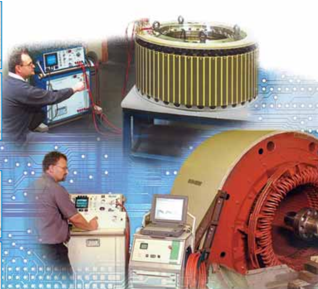
Elektrische Messungen nach VDE, z.B. Hochspannungsprüfung, Stoßspannungsprüfung, Teilentladungsmessung usw.
