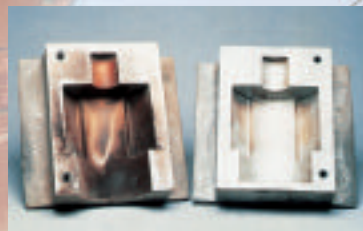
Abb. 6: Eine Metallform vor (links) und nach (rechts) dem Trockenschneestrahlen
