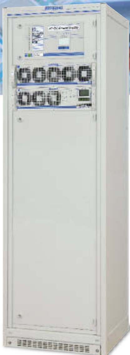
Fig. 8: Cabine onduleur-redresseur avec 3 modules onduleurs, un contacteur statique et un by-pass manuel 5 redresseurs modulaires de tension de sortie 230V DC avec un courant de 50A DC
