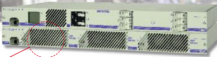
Fig. 9: Rectificador, Distribución SMS 4500: 2 x automático de batería, 3 x 48 V – 1500 W, 6 x fusibles de carga.
