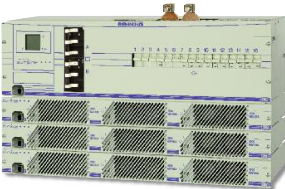
Fig. 11: Rectificador, Distribución SMS 13500: 2 x automático de batería, 9 x 48 V – 1500 W, 16 x fusibles de carga.
